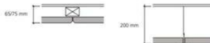
Typ 3: Träullit Akustik. Synligt alt dolt bärverk. Konstr höjd 65-200 mm.
