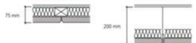
Typ 2: Träullit Akustik + mineralull. Synligt alt dolt bärverk. Konstr höjd 65-200 mm.
